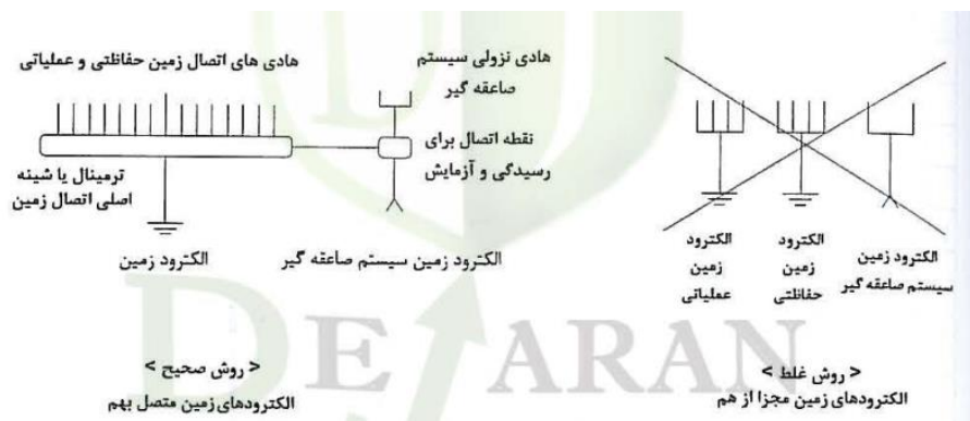
شکل ۱: کاربرد دو الکتروود زمین مستقل
