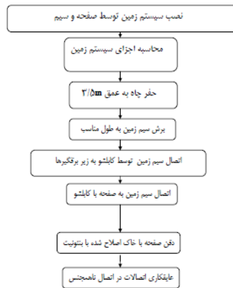
شکل ۸-۱- فلوجارت مربوط به مراحل نصب سیستم زمین شکل ۸-۲- شماتیک مربوط به مراحل نصب سیستم زمین توسط صفحه و سیم توسط صفحه و سیم
