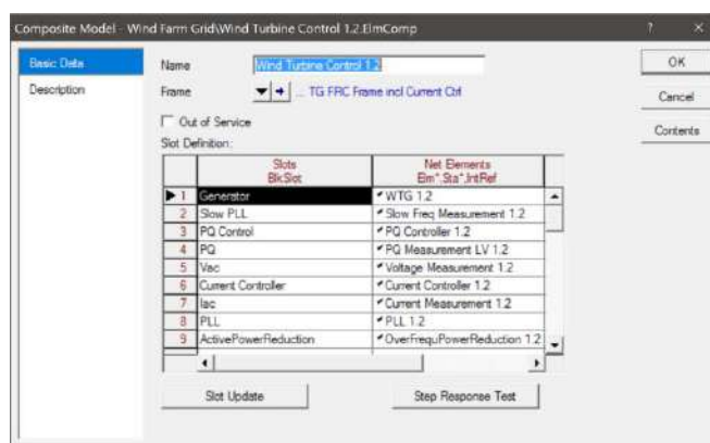
شکل (۲-۶۴): بلوک‌های کنترلی یک توربین بادی با اینورتر نامی
