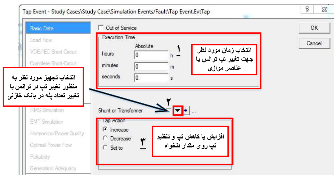
شکل (۵-۲۲): رخداد تغییر تپ ترانسفورماتور
